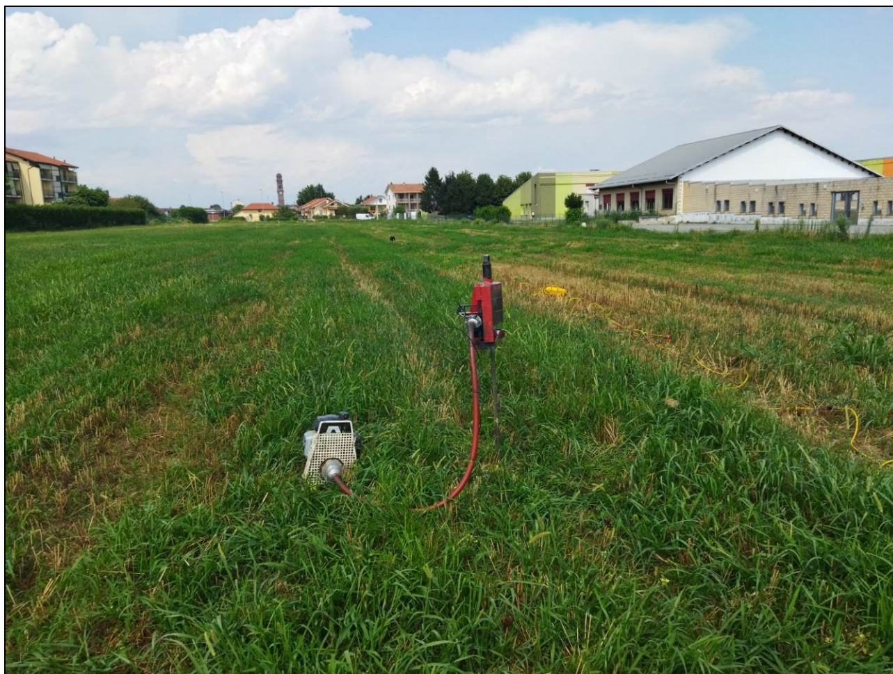
Figura 15: immagine fotografica della strumentazione utilizzata per la realizzazione della prova penetrometrica DPM-04 nell'area di intervento.
