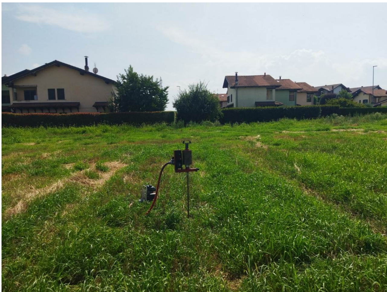
Figura 13: immagine fotografica della strumentazione utilizzata per la realizzazione della prova penetrometrica DPM-02 nell'area di intervento.
