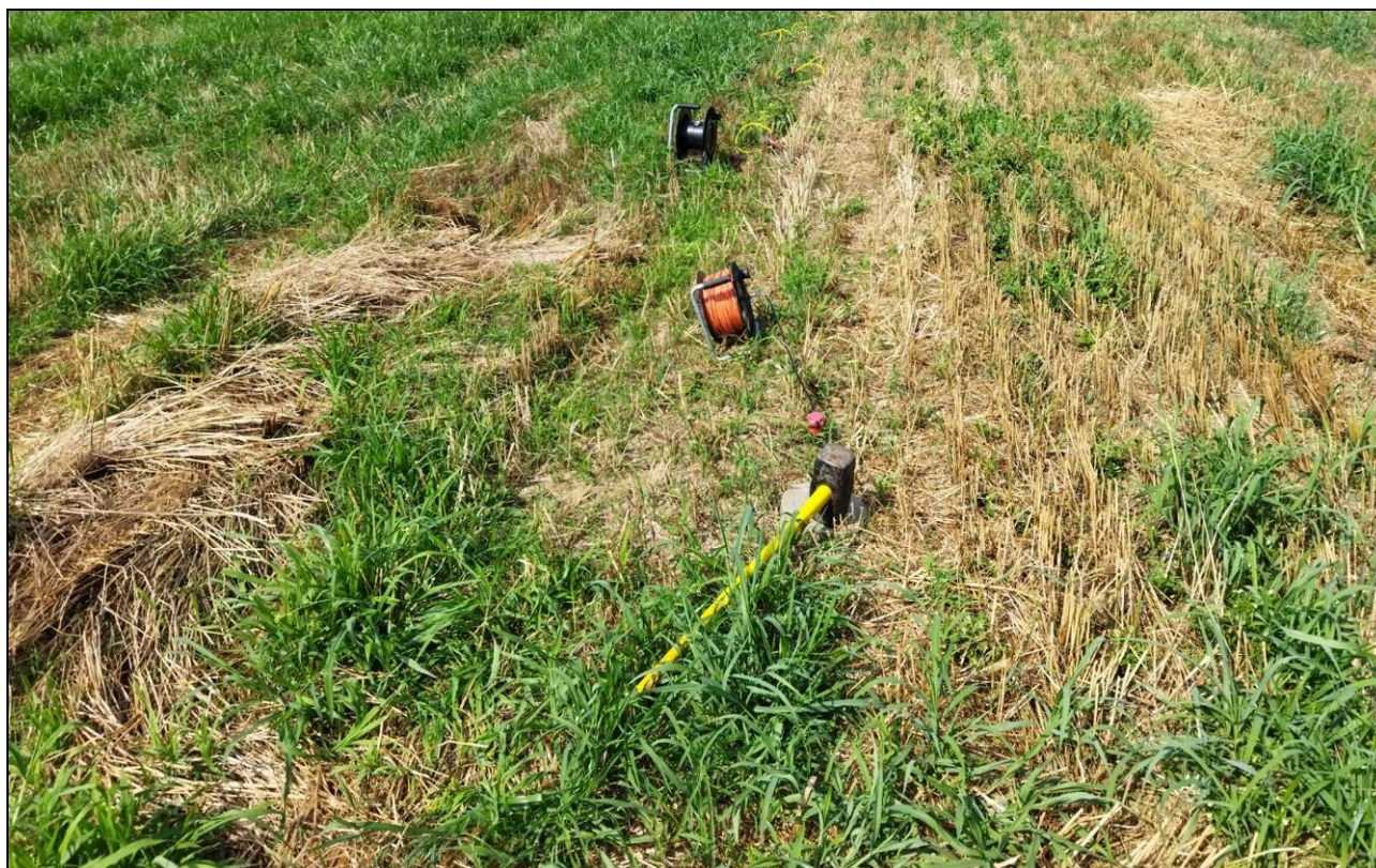
Figura 30: immagini fotografiche della posizione e della strumentazione utilizzata per la misura con tecnica MASW nell'area di interesse.
