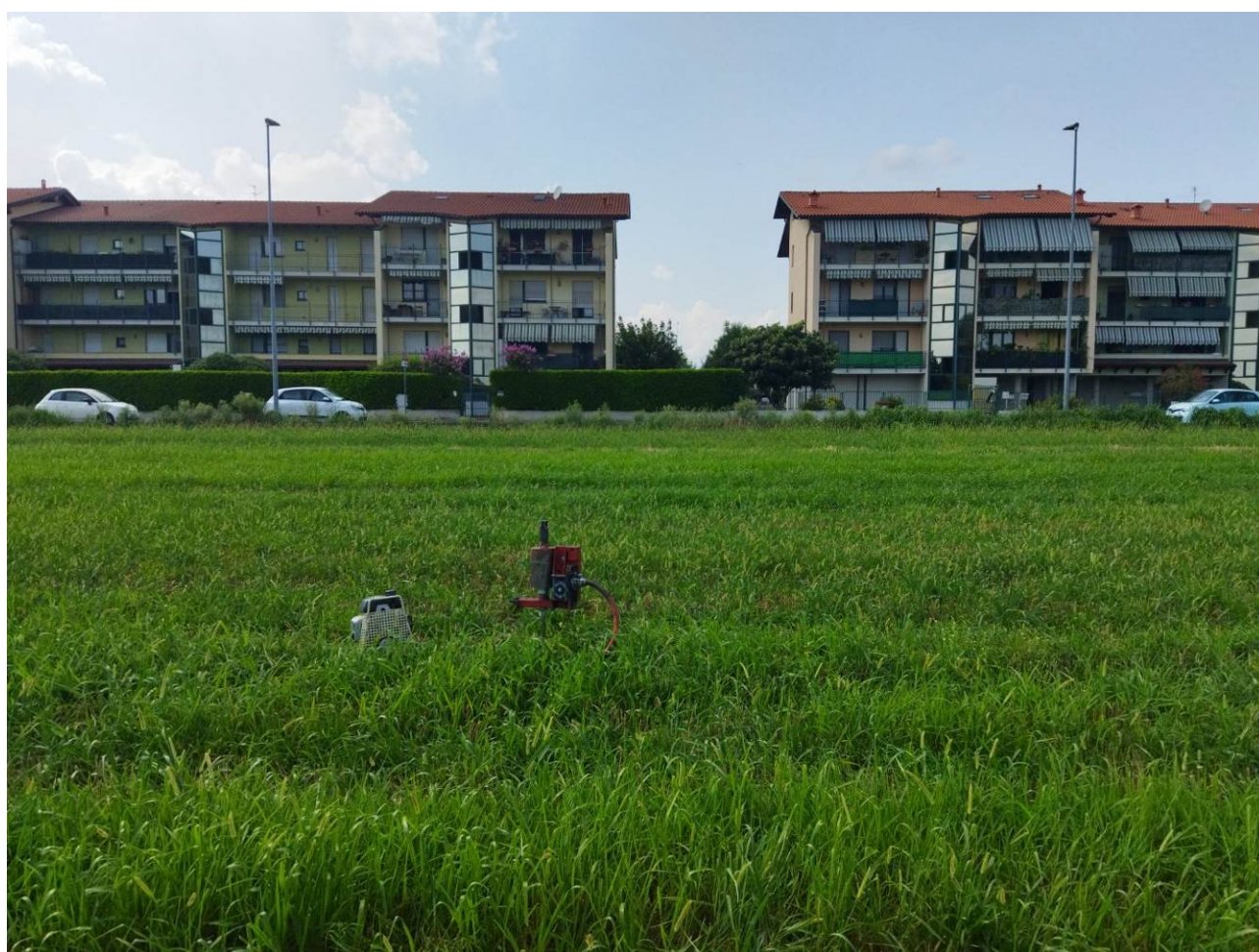
Figura 14: immagine fotografica della strumentazione utilizzata per la realizzazione della prova penetrometrica DPM-03 nell'area di intervento.
