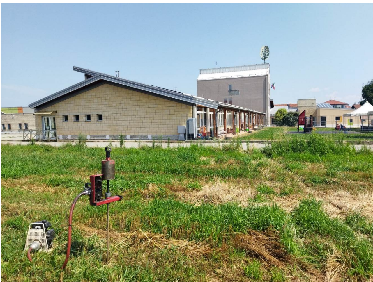
Figura 12: immagine fotografica della strumentazione utilizzata per la realizzazione della prova penetrometrica DPM-01 nell'area di intervento.
